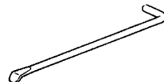
プラグ・レンチ・バー (兼ホイール・キャップ・レンチ)
