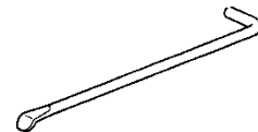
プラグ・レンチ・バー (兼ホイール・キャップ・レンチ)
