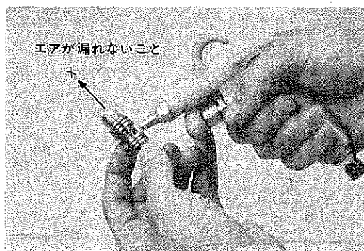
図6-6-21 コントロール バルブ点検 P5758
