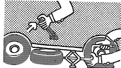
ジャッキがはずれると車が急に傾き大変危険です。
