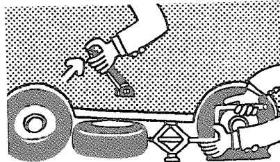
ジャッキが外れると車が急に傾き大変危険です。
