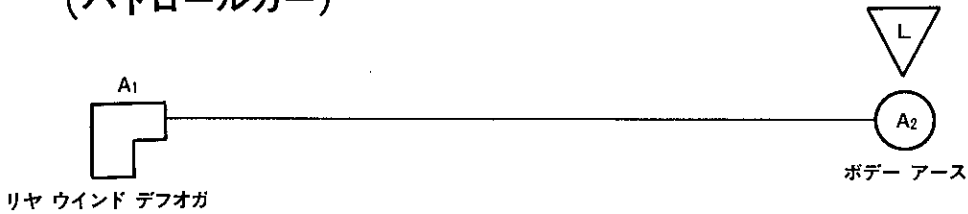
図31-1 ワイヤ サブ ASSY, リヤ ウインド デフォガ アース (1/1) (パトロールカー)
