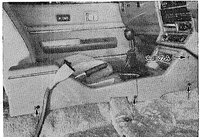
図15-3-4 コンソール ボックス取りはずし
