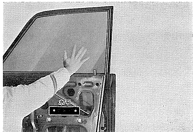
図15-2-18 イコライザ アーム ブラケット取り付け
