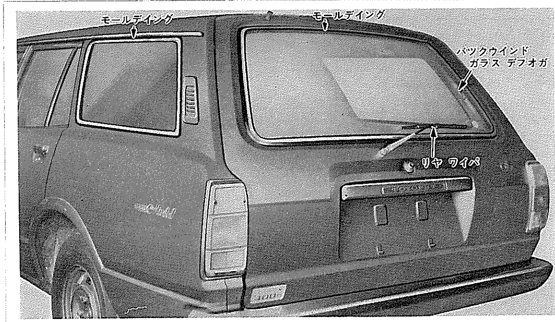
図15-1-42 バック ドア ガラス各部品取りはずし
