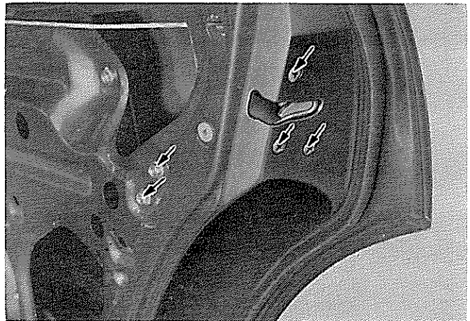
図15-2-53 ドア ロック取りはずし
