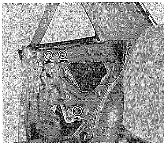
図15-1-65 ドア ガラスとのすき間調整
