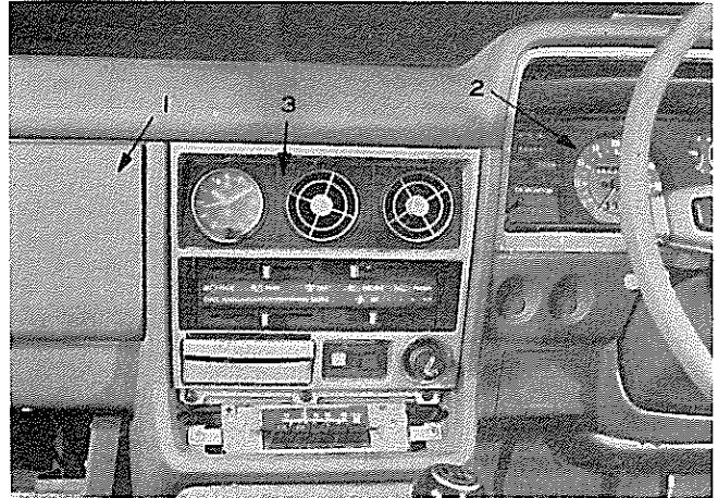
図14-144 スピーカ取りはずし (フロント用)
