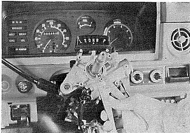
図8-39 スナツプ リング取りはずし
