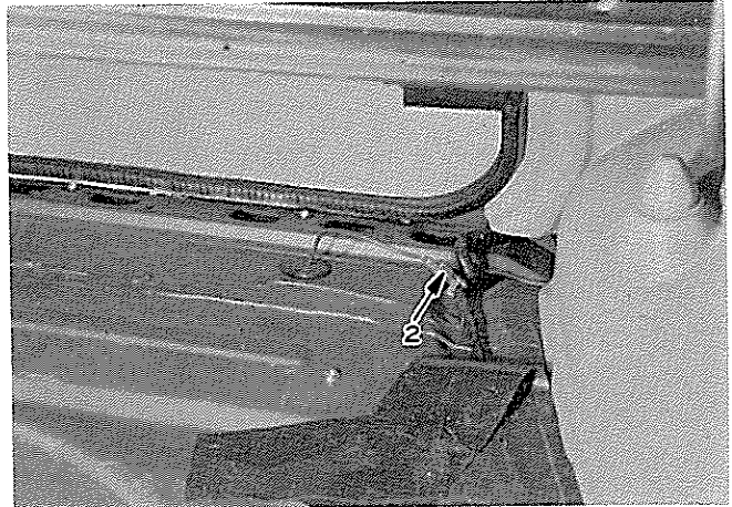
図3-2-15 フューエルポンプ取りはずし (その1)
