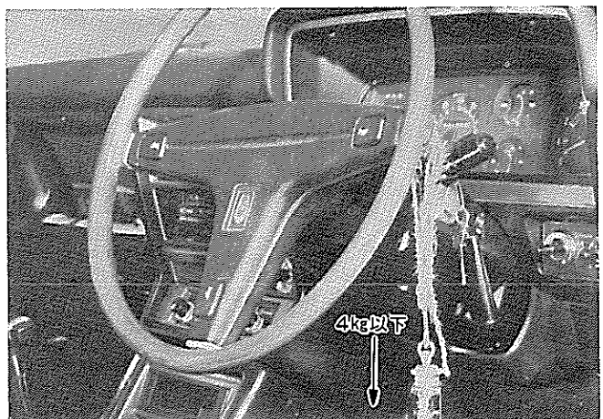
図12-62 据切り操だ力点検
