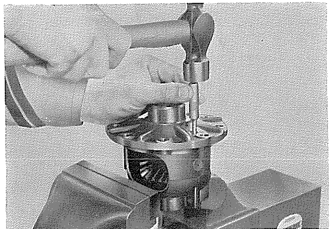
図9-116 ストレート ピン打ち抜き
