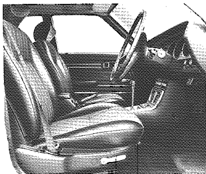
リクライニング・シート・ アジャスト・レバー アジャスト・ レバー
