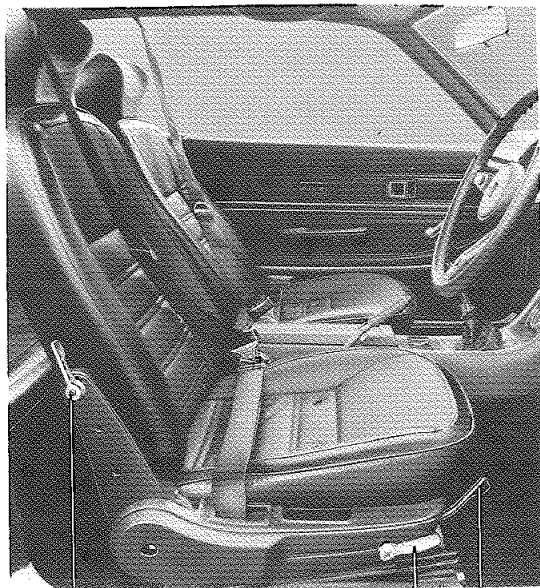
リクライニング・アジャスト・レバー シート・アジャスト・レバー リクライニング・アジャスト・レバー
