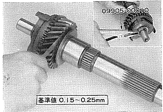
第4-72図 サード ギヤ スラストすき間 C1199 C1200
