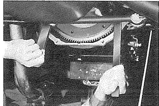
第8-19図 トルクコンバータ取りはずし
