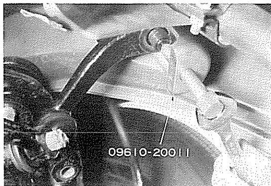
第13-27図 ピツトマンアーム取りはずし
